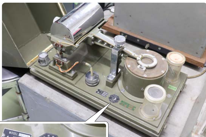
HESの水平動センサー部。左側の倒立振り子の揺れを右側のコイルと磁石で電気信号に変換して記録装置に送ります。台座には国際地球観測年のプレートも。
