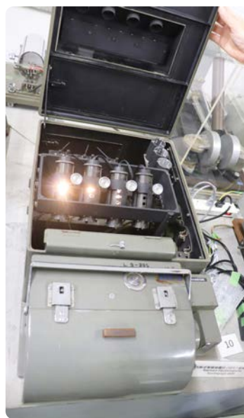
HESの記録装置。送られた電気信号を検流計の針の動きに変え、その針に取り付けられた鏡で光を反射・拡大して、手前の箱にセットした35mmカメラのモノクロフィルムに記録します。
