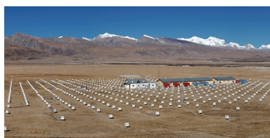
チベット高原（標高 4,300 m）に設置された 6.6 万 m 2 の宇宙線・宇宙ガンマ線空気シャワー観測装置。白い四角は 0.5m 2 の粒子検出器。Tibet AS γ 実験グループ提供。
