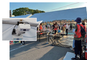
図3 いわき花火大会での人流計測実証において人流観測センサを設置している様子（2023年8月）
