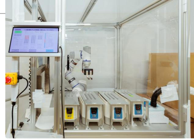
新たに導入された進化実験自動化ロボット 1度の操作で4日間休みなく稼働するため、実験効率が飛躍的に向上した。
