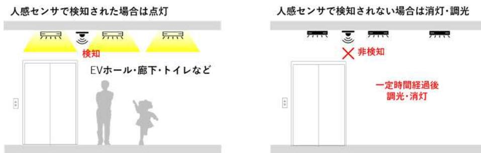
図 1 2 人感センサを用いた ON-OFF 制御イメージ
