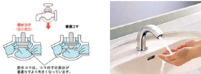
図 1 5 節水型水栓（左：節水コマ、右：自動水栓）
