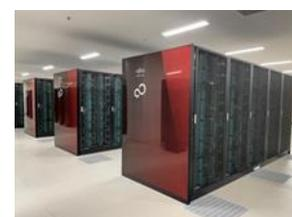
Tensorコア(GPU)を搭載した計算ノード45台からなるデータ・学習ノード群 (Aquarius、最大理論演算性能7.2ペタフロップス) の2つのノード群から構成される。2021年度の研究分野別利用ノード時間割合としては従来のスーパーコンピュータでも利用が多い工学系、地球・宇宙科学、材料科学、エネルギー・物理学が多くを占める一方、データ・学習ノード群は情報科学 (AI系) や生物情報科学の利用割合も高くなっている。
