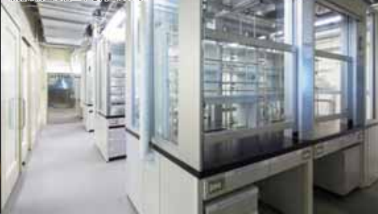
研究室～実験室コリドー（主として5～9階） 研究室と実験室を明確に区分しつつ、研究室からも実験室の状況が把握できるように間仕切壁にガラスを多用した
