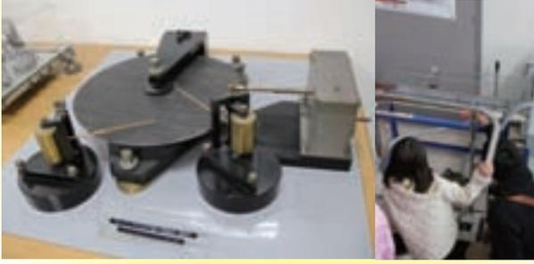
(左) レコードプレーヤーのようなおしゃれな地震計「ユーイング式地震計」。130年前に世界で初めてつくられた本格的な地震計のひとつです (右) 津波のメカニズムの実験を行う子供の姿も見られました
