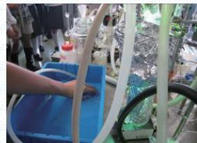
水中の光触媒に光を当てて水素を作る実験。青いパッドの水の中に、ホースの先からぷくぷくと水素が出てきます。
