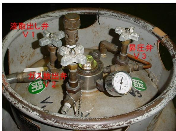
V<sub>1</sub>, 液取出し弁 ; 液体を汲み出す時に使用する。
